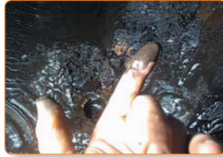
Отложения, смытые со стенок барабана котла
