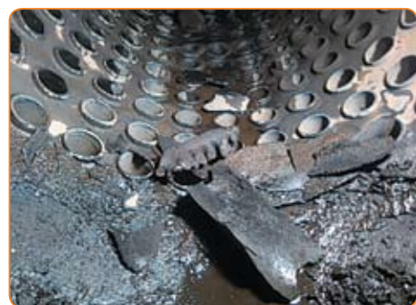
Сталактиты из накипи с питательной трубки парового котла
