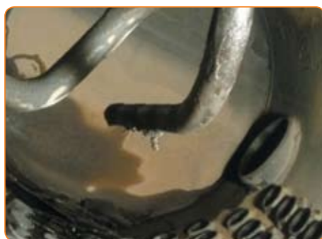
Сталактиты из накипи с питательной трубки парового котла
