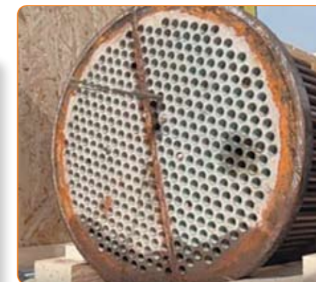
Промывка пучка кожухотрубного теплообменника
