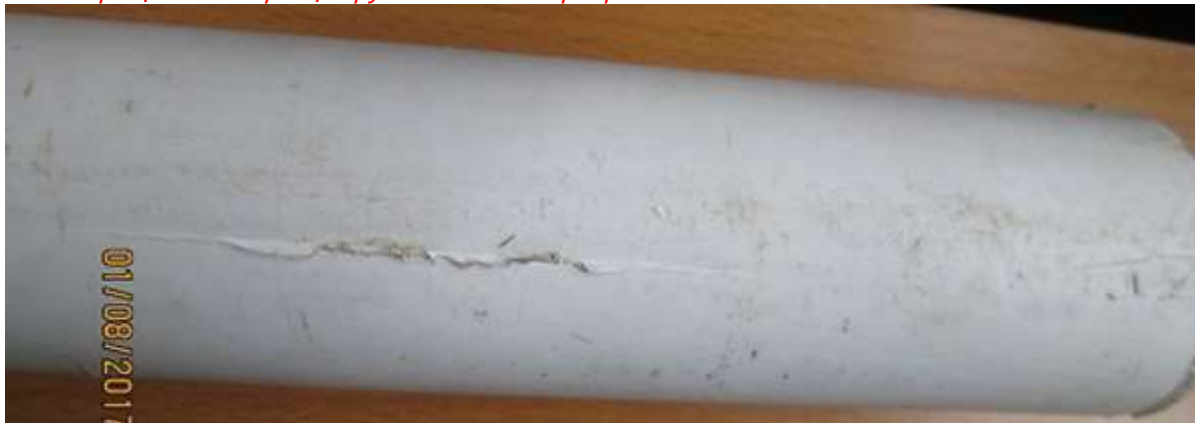
Рис. 1 Трещина на образце трубы PP-R без маркировки
