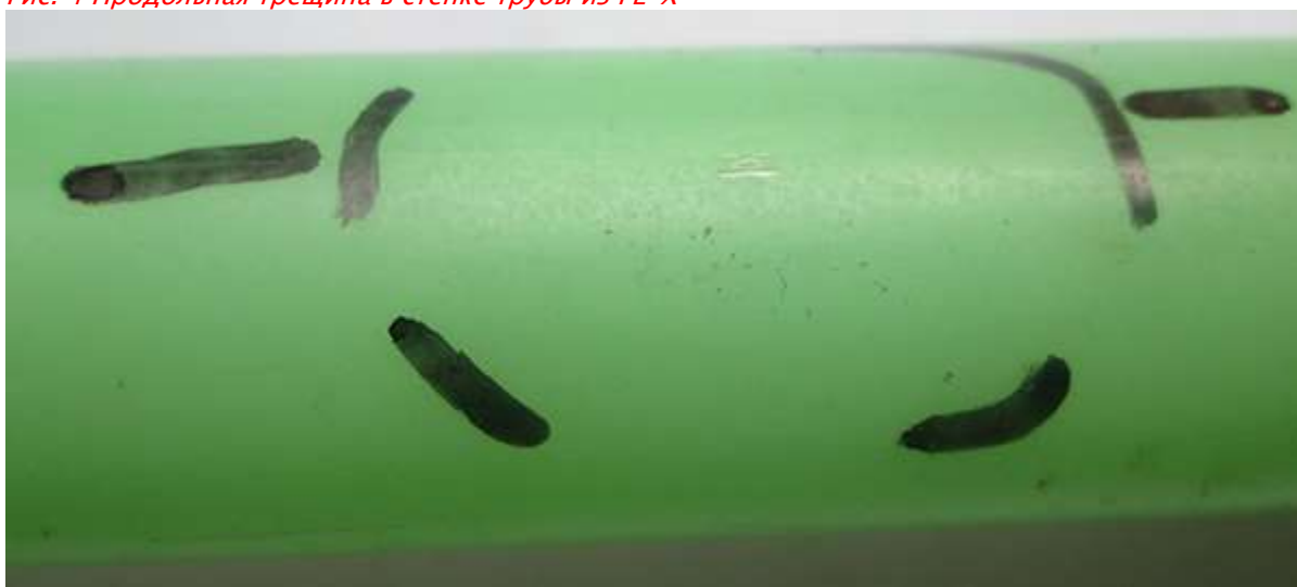
Рис. 4 Продольная трещина в стенке трубы из PE-X
