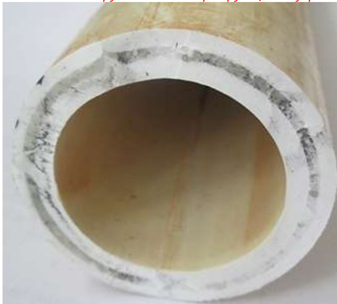
Рис. 2 Сечение трубы из PP-R с армирующим внутренним слоем из стекловолокна
